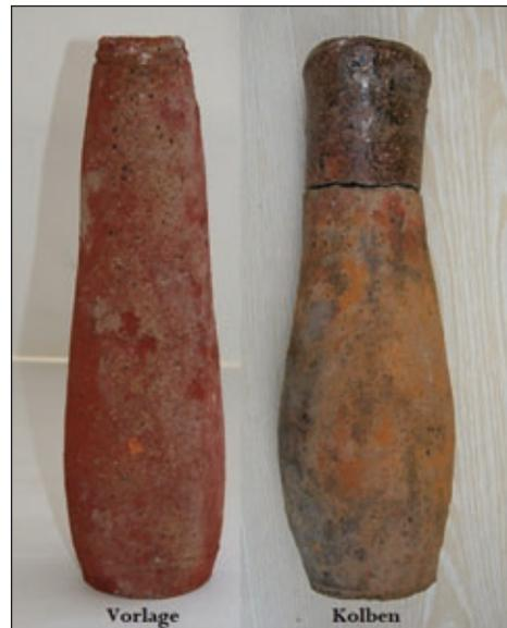
dauer zu reduzieren. Außerdem gelang es, die Retorten, die nach jedem Brennvorgang ausgetauscht werden mussten, durch Kolben und Vorlagen aus Waldenburger Ton zu ersetzen. Diese konnten bis zu zehnmal wiederverwendet werden.
